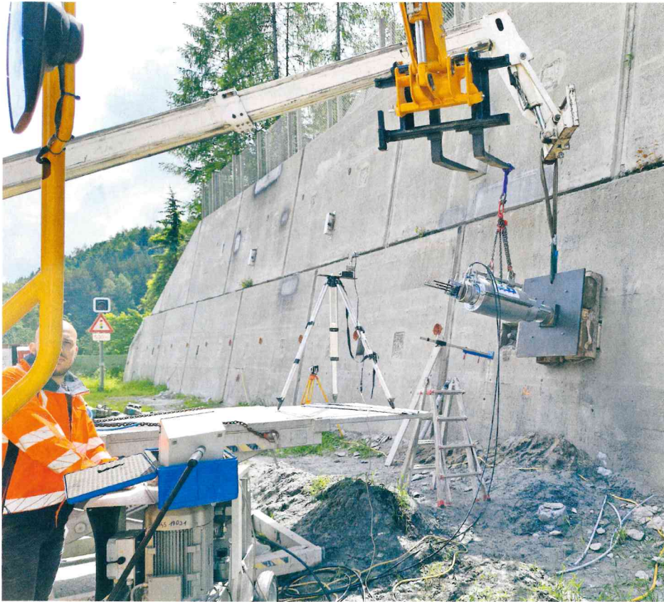
Mit einer hydraulischen Presse wird die Tragfähigkeit eines Eignungsprüfungsankers ermittelt und die Ankerlänge aufgrund der Daten optimiert.
